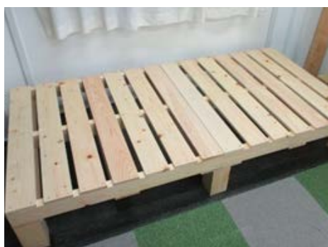
15 約 2.5cm 間隔で残りの上板をビス (40mm) で止めていきます。
