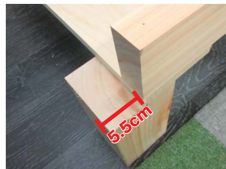
11 ベッドの中心にくる脚材の約 5.5cm に印をつけ、パレットを置きます。
