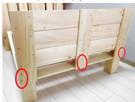
17 出来上がった背材をパレットの横にビス (40mm) で止めます。
