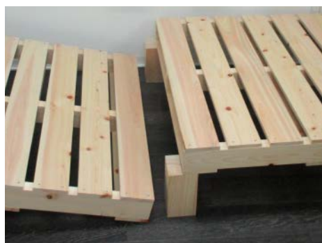
12 このとき片側しかパレットを固定しないことで、解体が容易になります。
